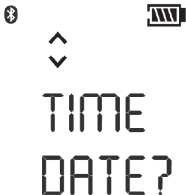
Figur 7 Inställning av tid och datum
